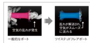
ノイズの原因となる、ポート端部の空気の流れ
