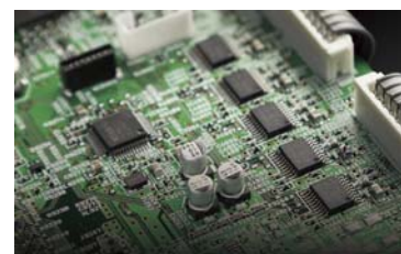
最新世代バーブラウンDACを採用したオーディオ基板
