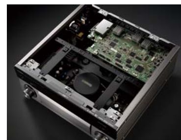
H型クロスフレーム&ダブルボトム構造の制振・高剛性シャーシ
