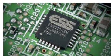
ESSテクノロジー社製の 32bit・2ch仕様高性能D/Aコンバーター
