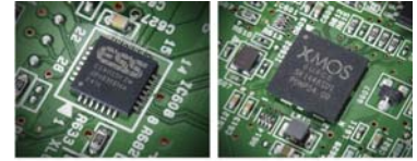
左：ESS 社製 32bit D/A コンバーター「SABRE 32」 右：XMOSS 社製 USB デバイスコントローラー IC
