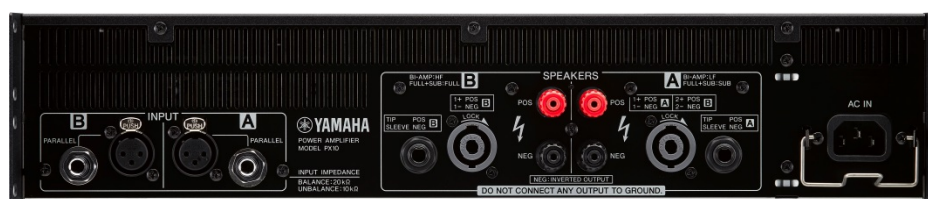
パワーアンプリファイアー『PX10』リアパネル
