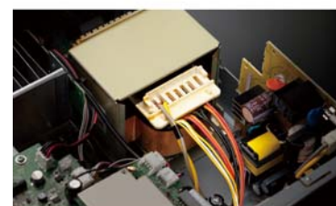
デジタル系/映像系/オーディオ系/表示系を分けた 4回路分離パワーサプライ
