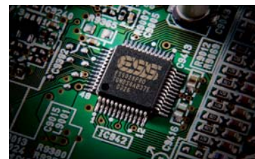
最新世代のESS社製フラッグシップD/Aコンバーター「ES9026PRO」
