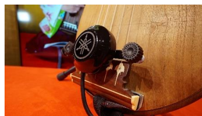
電気信号を振動に変換して 楽器の自動演奏を可能にする装置
